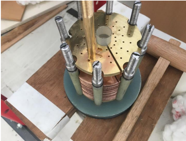
Figure1 パルスマグネットのコイル部分をうえからみた図
